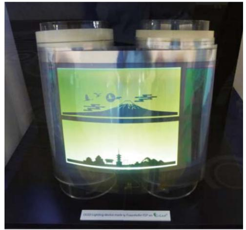
欧州最大の応用研究機関Fraunhofer(フ라운ホーファー)研究機構が開発中の「フレキシブルガラス基板を用いたロールtoロールによる有機EL照明の製造プロセス」に、当社の超薄板ガラス<G-Leaf>が基板材料として採用され、Fraunhoferと共同でロールtoロールおよびシートtoシートでのプロセスを開発中です。
