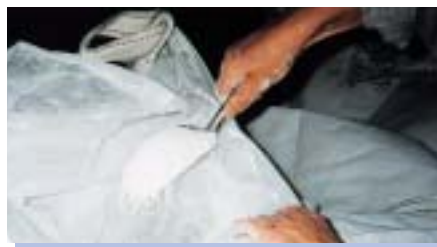
スプレードライヤーにより造粒されたガラス原料
