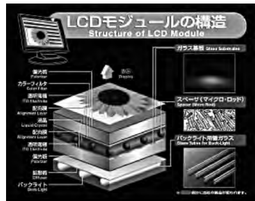
図1 LCDの構造とガラス基板
