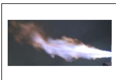
水素 60% / 天然ガス 40%
