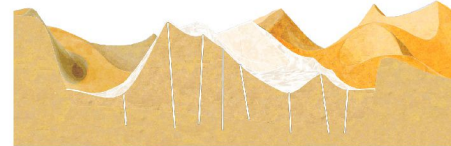
砂丘の表面に現場打ちのガラスの屋根を架ける。その時の砂丘の形を記憶する。
