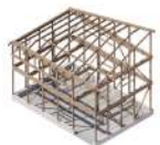
既存の空き家住宅の床と間柱を抜いたスケルトンの状態。
