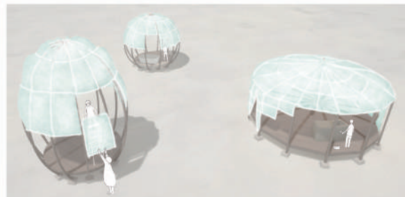
グラスウールバックを繋げるだけで、屋根と壁が出来上がるため、誰でも施工ができる。
