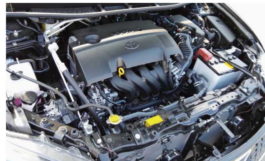
エンジンルーム内の金属代替用品材料として使われるFRTP(ガラスファイバ強化熱可塑性樹脂)製品
