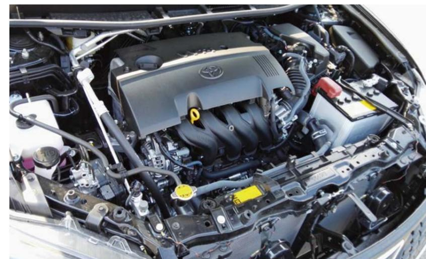
作为发动机舱内的金属替代材料的FRTP (玻璃纤维强化热可塑性树脂)产品
