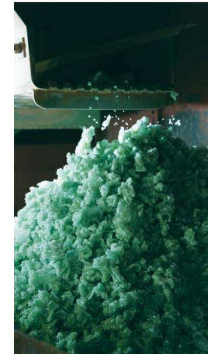
通过循环工序回收的原料玻璃 (MG※)
