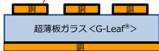
銅メッシュタッチセンサーシート断面構造
