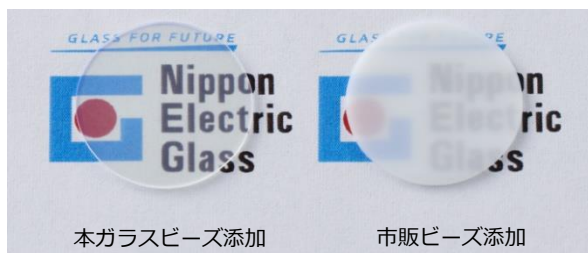
同量（30vol%）のガラスビーズを添加し、造形した樹脂の外観比較（厚み 0.5mm）
